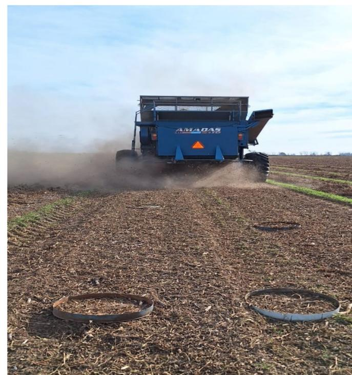
Figura 5. Aros ciegos utilizados para la Evaluación de la cosechadora de maní.
